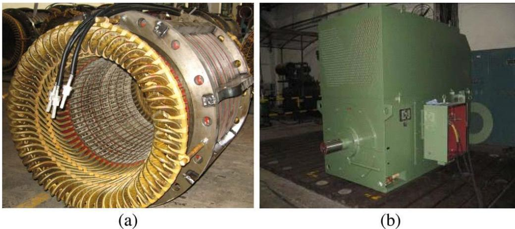
Рис. 11 Изготовленные опытные образцы. (а) Гибридная обмотка. (б) Опытный образец в сборе.
